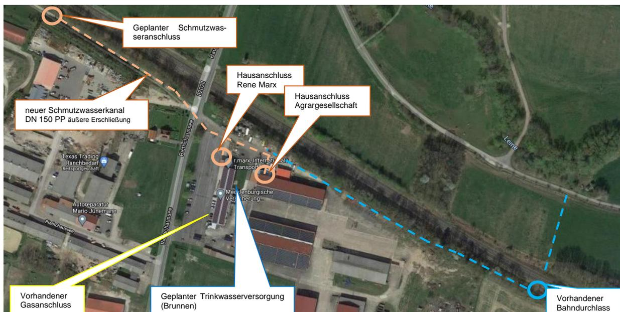
Lageplan der vorgelegten Anschlussmöglichkeit für Schmutzwasser und geplanter Anschluss an das öffentliche Netz und allen andern Ver- und Entsorgungsanlagen
